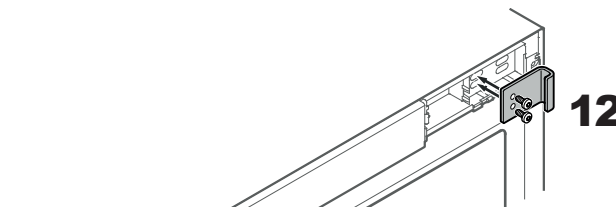
12. A szemközti oldalon csavarozza vissza a záróidomot.
